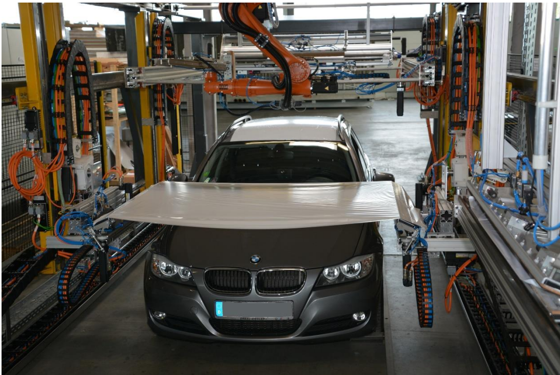
Die Pilotanlage verfügt über zwei verfahrbare Rahmen zum Aufspannen der Folie und ist damit für die Integration eines weiteren Roboters zur Verkürzung der Bearbeitungszeit vorbereitet. (Foto: Roßmann)
