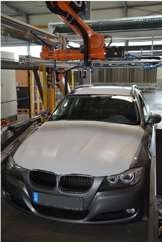
Ein robotergeführter Rakel drückt die Folie an die Karosserie und streicht Blasen und Falten heraus, wobei der Rahmen die Folie in der optimalen Bearbeitungsposition hält. (Foto: Roßmann)
