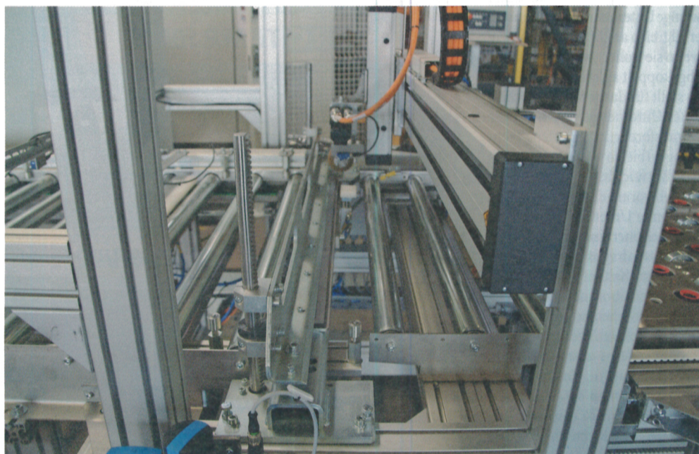
Im ersten Bearbeitungsschritt wird in einem definierten Randbereich die Folie mit einer rotierenden und entlang der Stirnseite verfahrenen Bürste leicht angehoben. Foto: K-ZEITUNG/Kögel
