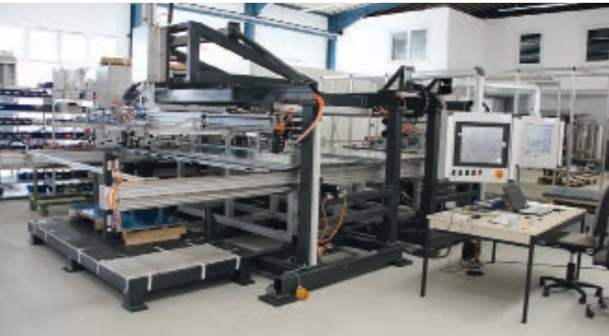
Die komplette Anlage besteht aus einem Einlagerplatz für die Bleche, zwei Bearbeitungstischen zum Einritzen und Abziehen und einem Auslagerplatz.
